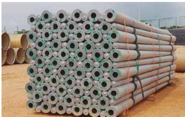
Postes para el tendido de líneas y columnas de alumbrado fabricadas con PRFV: garantía de seguridad y sostenibilidad.
