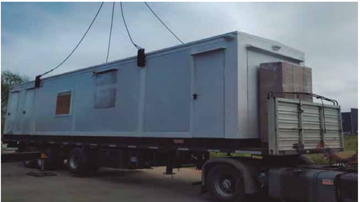
Figura 7. Aplicación de cogeneración en Central Puerto “San Lorenzo”, de Siemens: salas eléctricas de 500 y 132 kV, de 13,3 m de largo, 2,6 de ancho y 3 de alto
