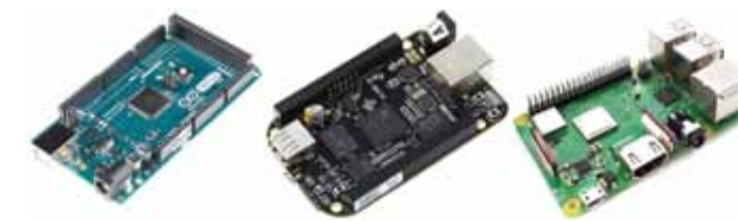
Figura 5. Alternativa de dispositivos embebidos para implementar el control del sistema: Arduino (izquierda), Beaglebone Black (centro) y Raspberry Pi (derecha)
