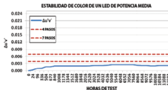
Figura 8. Resultados de ensayos LM-80 de leds encapsulados cerámicos luego de 11.592 horas a 105 °C
