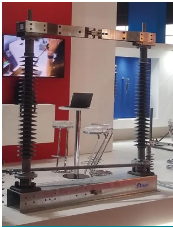
Seccionador de dos columnas rotativas de alta tensión (145 kV) con aisladores de silicona.
