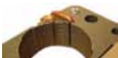
Figura 18. Estator de un motor eléctrico monofásico con la bobina o espira de sombra de polo
