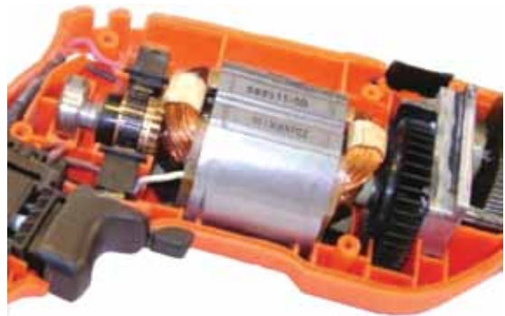
Figura 14. Aplicación típica de un motor serie en un taladro
