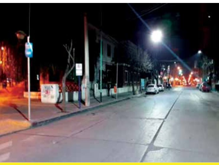
Figura 4. C. H. Rodríguez casi diagonal Alvear, una iluminada con led y la otra, con sodio
