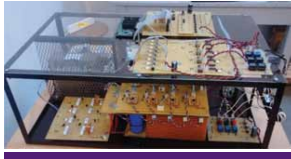
Figura 14. Implementación final del inversor trifásico
