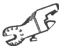
Soporte de la herramienta P/N 396349-2 Con la pértiga universal sostiene la herramienta preparándola para la fijación del conector
