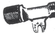
Martillo P/N 69674 Tomando sobre una pértiga universal, se golpea con él la culata de la herramienta logrando la fijación del conector
