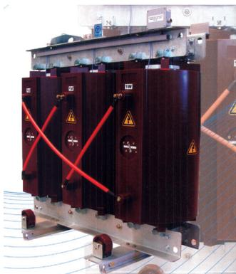
mantenimiento posterior a la instalación. Se fabrica en potencias normalizadas desde 350 hasta 2.500 kVA, tensiones primarias de 13,2 y 33 kV y frecuencias de 50 y 60 Hz. La construcción y ensayo de estos equipos responden a las normas IRAM e IEC 726/76.
