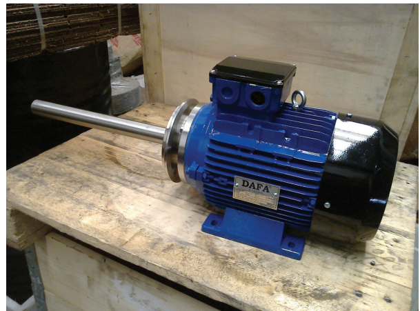
Motor trifásico especial: eje inoxidable
