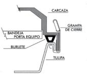
te su tranasparencia en el tiempo. Las grampas de cierre, de accionamiento manual e imperdibles, aseguran el difusor sobre la carcasa y pueden ser de hierro cincado o acero inoxidable AISI 304.
