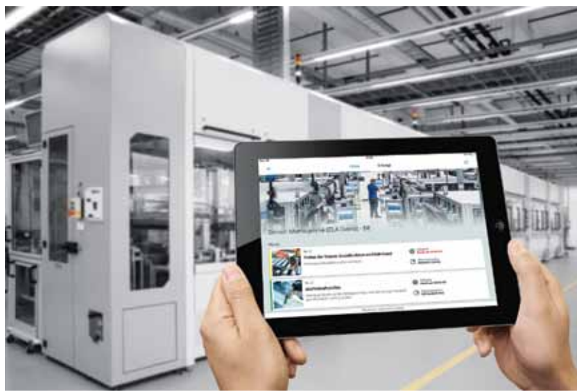
Festo "Productivity Master": el sistema de producción para memorias USB personalizadas demuestra los beneficios de la conectividad mecánica, eléctrica e inteligente en sus cinco estaciones.
