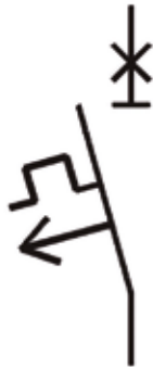
Figura 1. Interruptor termomagnético automático bipolar (izq) | Figura 2. Símbolo unipolar (der).
