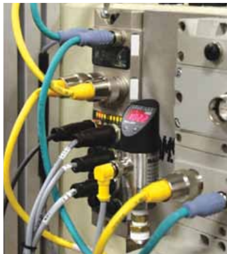
Figura 9. Maestro IO-Link Ethernet/IP con sensor de presión inteligente
